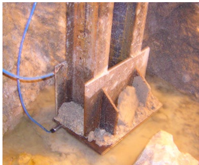
Cellule de charge en pied de cintre (plaques de répartition fortement recommandées)
